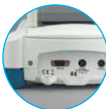
Interface RS -232, connexion anti-vol et mise à niveau
